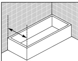
Il rilevamento delle misure deve essere effettuato a completamento messa in opera dei rivestimenti, prendendo le misure da muro al bordo esterno della vasca.
