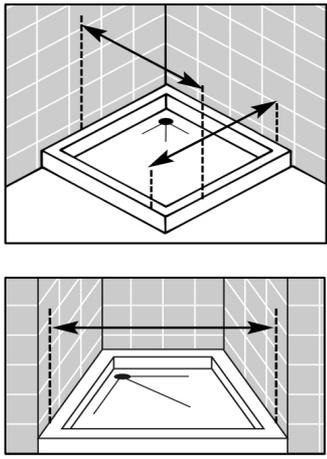
Il rilevamento delle misure deve essere effettuato a completamente messa in opera dei rivestimenti, prendendo le misure da muro a muro nella versione a nicchia oppure dal muro al bordo esterno del piatto nelle altre versioni.
