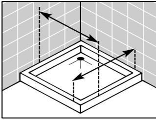
Il rilevamento delle misure deve essere effettuato a completamente messa in opera dei rivestimenti, prendendo le misure da muro al bordo esterno del piatto.
